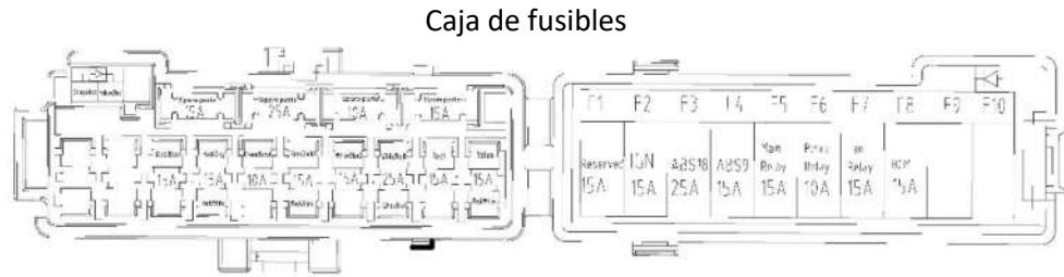
Este modelo cuenta con un fusible principal, 8 fusibles en caja de fusibles junto con 4 de repuesto (como se muestra en la imagen de la derecha).
