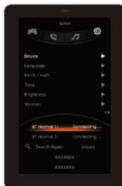
Conexión del equipo, ajuste del idioma, sistema métrico/imperial, ajuste de la hora, ajuste del brillo, información de la versión y recuperación de los ajustes de serie.
