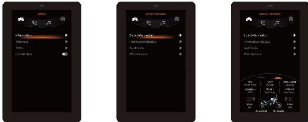
En la página de información básica, el usuario puede consultar la tensión de la batería, el tiempo total de conducción, la temperatura del refrigerante, el kilometraje total, la velocidad media, el consumo medio de combustible, la presión y la temperatura de los neumáticos.
