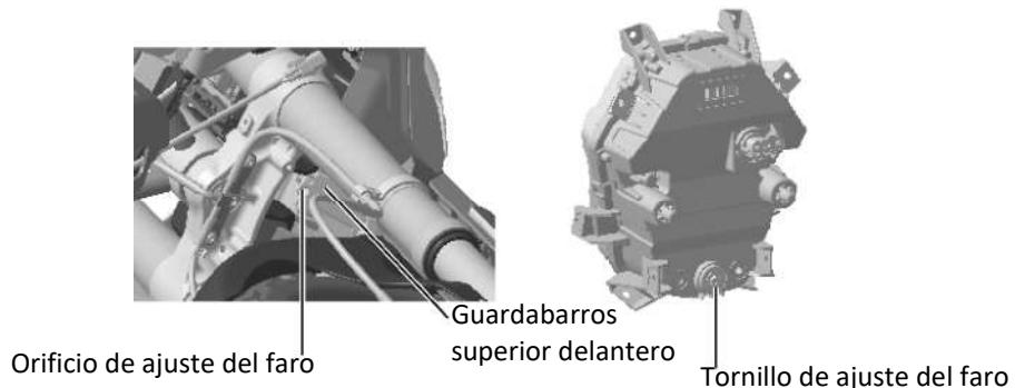
El faro debe mantener una altura razonable bajo diferentes cargas de las suspensiones.
