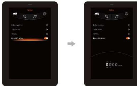
Cambiar de marcha a la velocidad de rotación adecuada puede reducir eficazmente el impacto en el selector de cambio y proteger el embrague. Activar y restablecer el aviso de cambio a una marcha superior ayuda al conductor a familiarizarse con la motocicleta más rápidamente. Por defecto, el régimen preajustado para un cambio a una marcha superior es de 6.500 rpm.
