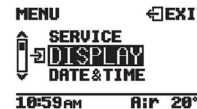
1. Pulse el botón SELECT (arriba o abajo) para seleccionar uno de los elementos. El elemento seleccionado se indica mediante una flecha en el centro de la pantalla y aparece resaltado. La barra de desplazamiento a la izquierda de la pantalla se mueve con la selección del elemento.
