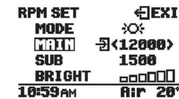
2. Presione el interruptor SELECT (arriba o abajo) para configurar las RPM preestablecidas. El rango de ajuste va de 5000 a 14300 rpm en incrementos de 100 rpm. El tacómetro muestra las RPM preestablecidas.
