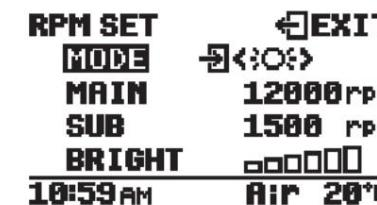
2. Pulse el interruptor SELECT (arriba o abajo) para seleccionar la iluminación (LUZ, INTERMITENTE, APAGADO) de las luces indicadoras de rpm del motor. El indicador de rpm del motor 7 está vinculado a la selección de LUZ o INTERMITENTE.
