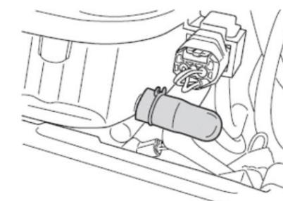
Retire el tapón y drene el agua y el aceite durante el mantenimiento periódico. El tapón de drenaje del filtro de aire se encuentra debajo de la carcasa del filtro.
