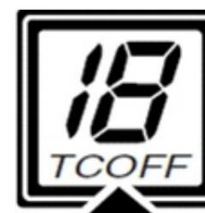
La configuración del sistema de control de tracción se indica como TC OFF, de 1 a 10.
